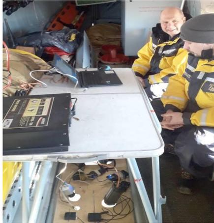
**Рисунок 4.2.11 Работа операторов на борту самолета, под столом установлены фотокамеры и тепловизоры**
