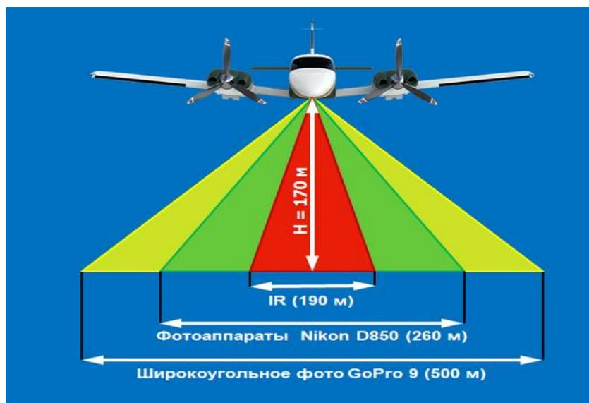
**Рисунок 4.2.4 Полосы обзора авиасъемочной аппаратуры**
