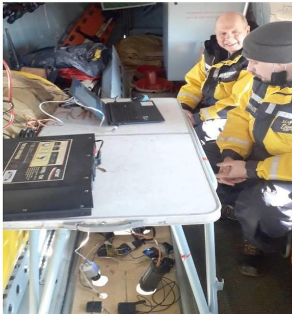
Рисунок 4.2.11 Работа операторов на борту самолета Piper PA-34, под столом установлены фотокамеры и тепловизоры
