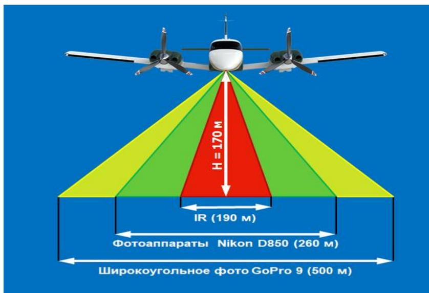
Рисунок 4.2.4 Полосы обзора авиасъемочной аппаратуры
